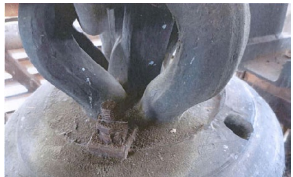
La bélière (anneau au centre de la cloche qui permet au battant de balancer) est cassée. Elle a été remplacée par une fausse bélière soudée sur une plaque ronde.
